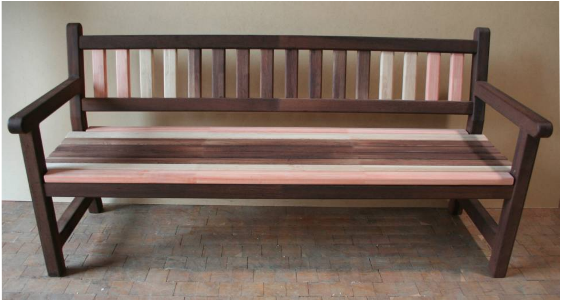
Abb. 5: Gartenbank - Vergleichstest zur Verklebung von unbehandelten gegenüber unterschiedlich stark modifizierten Proben
